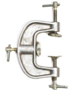
Prensas metálicas con juntas de goma para anclajes.
